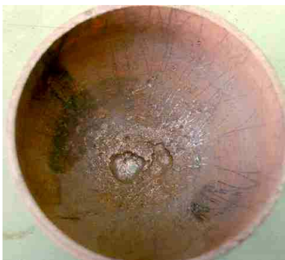
Corrosion dans le fond d'une bouteille de plongée.
